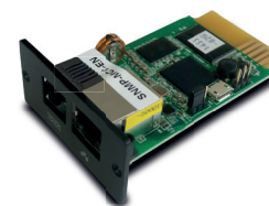
Tarjeta opcional: EMD (Dispositivo de monitoreo ambiental)
